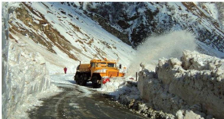
*Рис. 3.* Уборка снежной массы с проезжей части снегоочистителем
