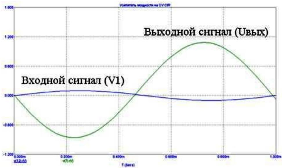
Рис. 2. Форма сигнала (напряжения) на входе и выходе усилителя мощности
