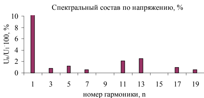
Рис. 5. Спектр напряжений при отключенных БСК
