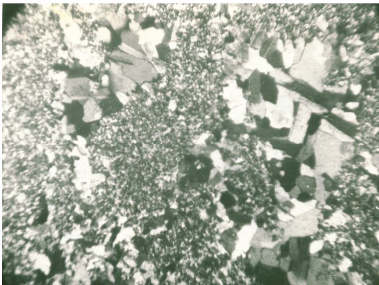
Рис. 9. Гидротермально-метасоматически измененные фельзиты. Относительно крупнозернистый альбито-кварцевый материал образует постепенные переходы к тонкозернистым метасоматически переработанным участкам существенно-кварцевого состава. Структура гломеробластовая. Николи скрещены. Увел. 100.
