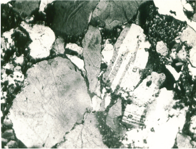
Рис. 7 б. Полимиктовый песчаник в основании базального горизонта J_1^1 ; кластический материал неотсортирован. Николи скрещены. Увел. 50.
