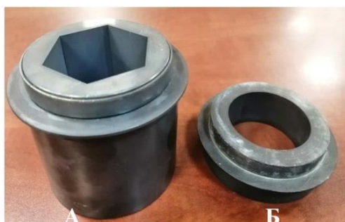
Рис. 3. Шестигранная втулка (А) в сравнении с обычной втулкой (Б)
