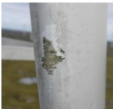
Рисунок 1 – Разрушение верхнего слоя из-за попадания воздуха в процессе производства
