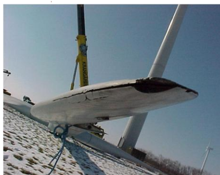
Рисунок 2 – Повреждение от удара молнии
