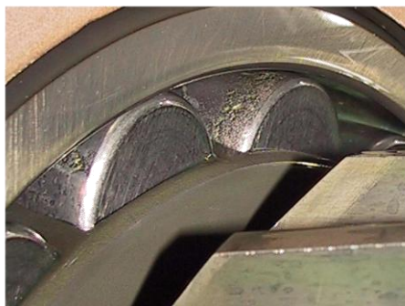
Рисунок 4 – Глубокий износ подшипников
