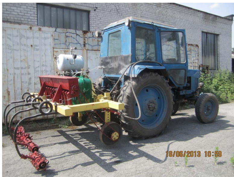
Рис. 3. Экспериментальный образец блок-модуля опытного агрегата для подсева трав с предпосевным внесением жидких минеральных удобрений и последующим прикатыванием
