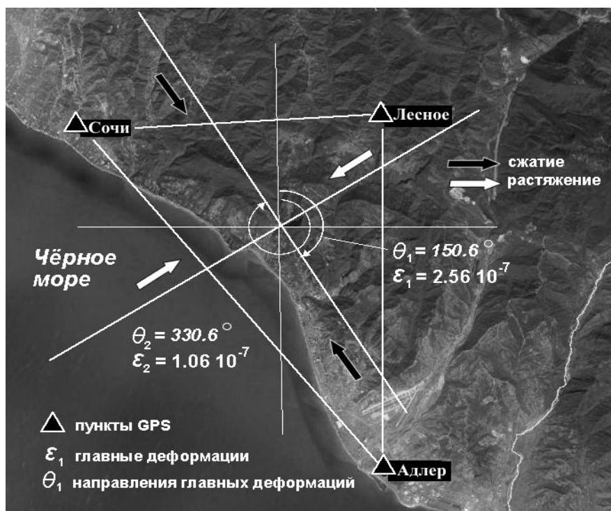
Рис. 8. Главные деформации района Большой Сочи в треугольнике СГП Адлер, Сочи, Лесное
