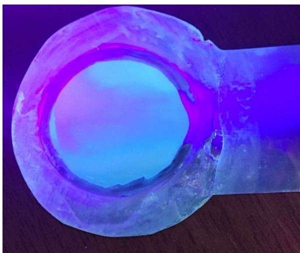
Рис. 5. Фотография образца № 4, изготовленного анодированием в ортофосфорной и щавелевой кислотах, после УФ-облучения
