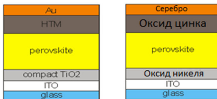
Рис. 1. Структурные схемы солнечных элементов на основе перовскита (слева – существующая, справа – разработанная)
