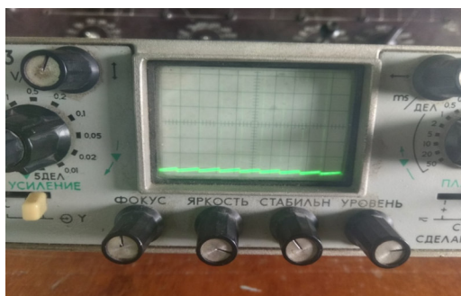
Рис. 5. Временная диаграмма схемы преобразователя напряжения
