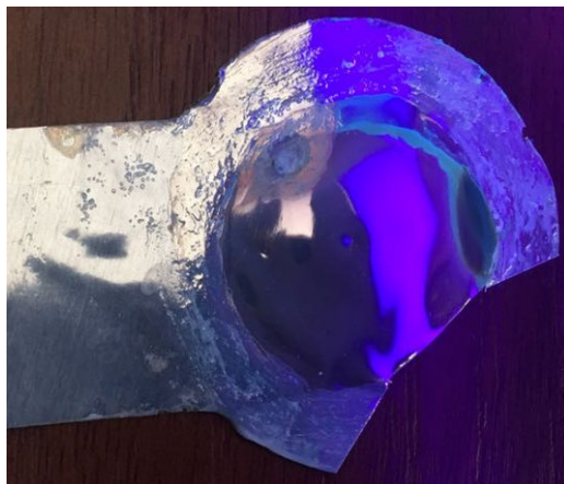
Рис. 6. Фотография образца № 3, изготовленного анодированием в ортофосфорной кислоте, после УФ-облучения
