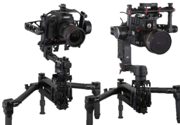
Рис. 2. Электронный механизм 3-х осевой стабилизации
