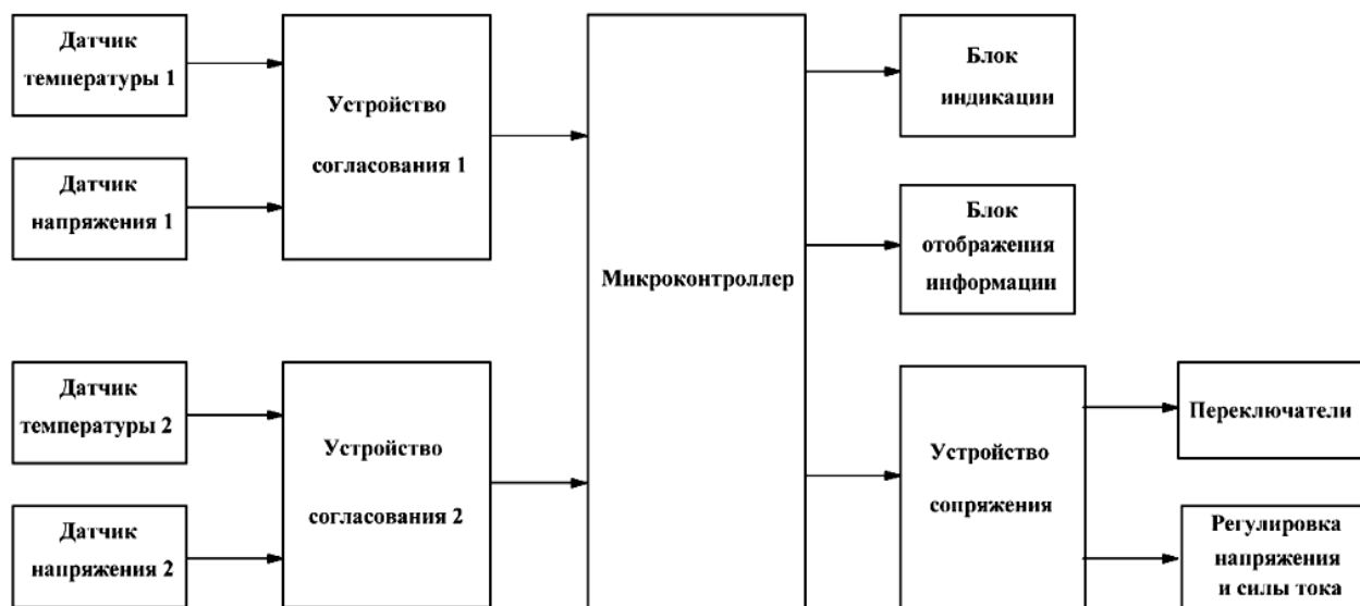
Рис. 1. Схема электрическая структурная блока управления зарядно-пусковым устройством
