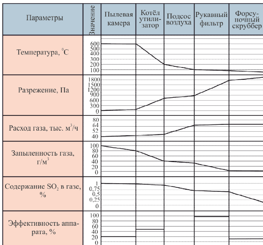
Рис. 4. Эксплуатационные характеристики работы системы очистки газов процесса вельцевания цинковых кеков на основе мокрого метода
