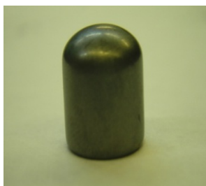
Рис. 3. Твердый сплав, для армирования шарошечных долот Г2650 (марка ВК8В)
