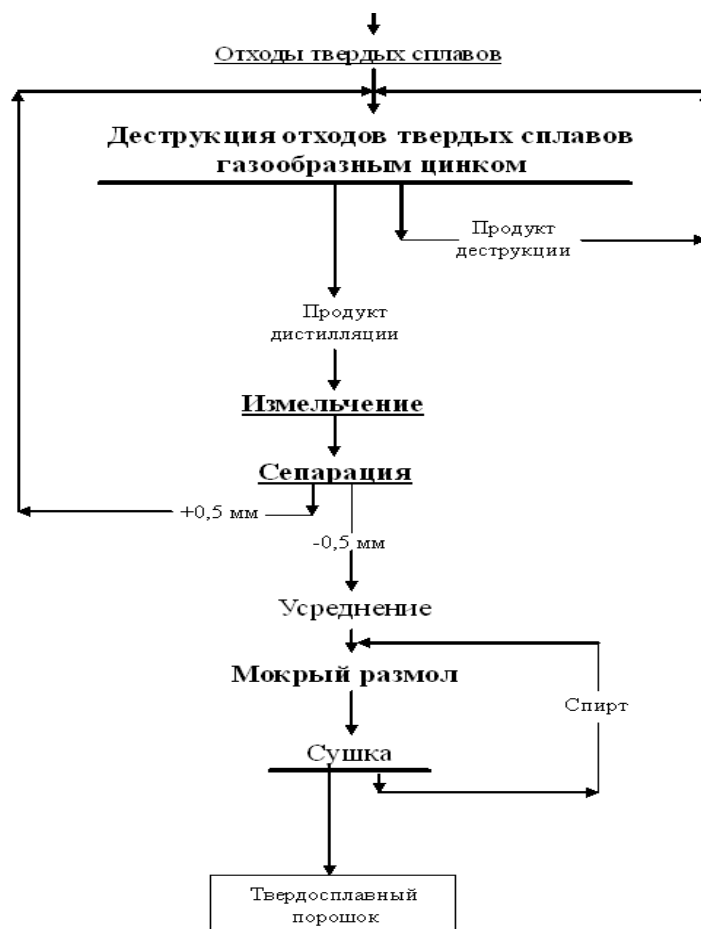
Рис. 1. Структурная схема переработки отходов твердых сплавов с совмещением процессов деструкции парами цинка и дистилляции в одном рабочем пространстве
