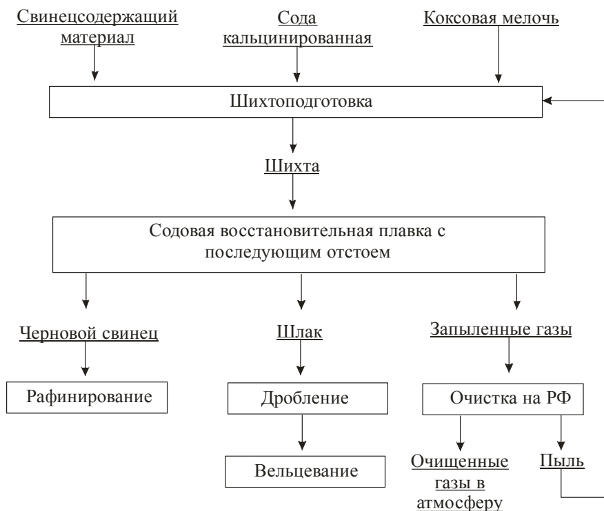
Рис. 1. Технологическая схема содово-восстановительной плавки
