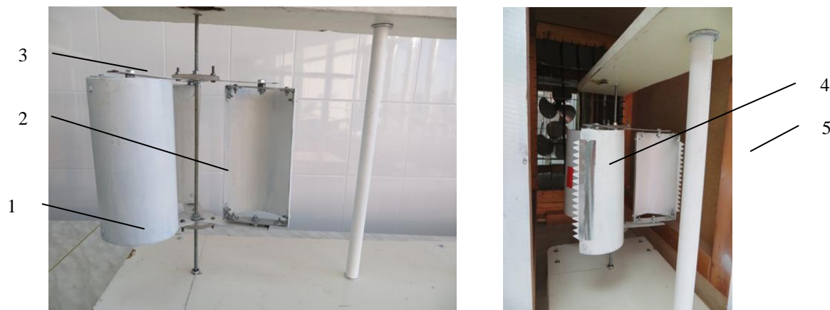
Рисунок 2 – Лабораторная установка по исследованию частоты вращения карусельного ротора:
