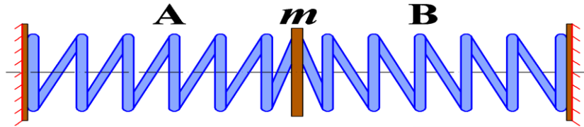
Рисунок 4 - Модель влияния запаса упругой энергии сжатого газа на развитие повреждений в стенке газопровода
