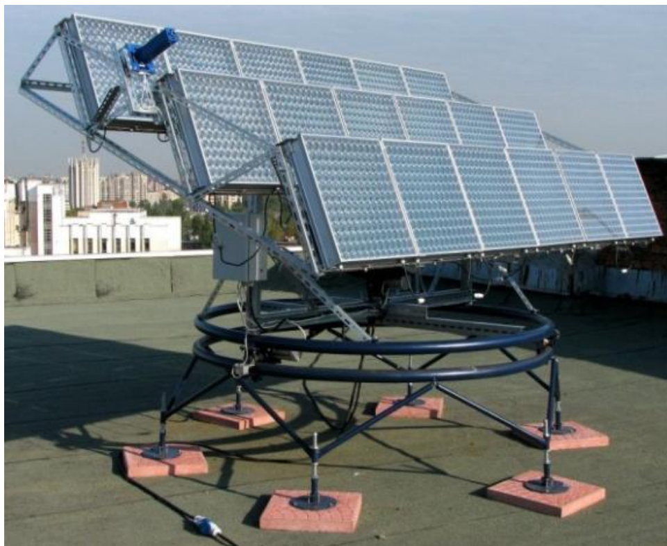
Рисунок 5 – СФУ с оптическими концентраторными модулями, установленная на крыше корпуса «А» ФТИ им. Иоффе
