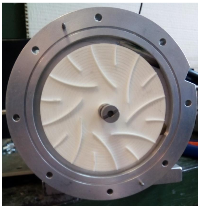
Рисунок 1 – Изготовленное методом 3d-печати колеса микротурбинной установки
