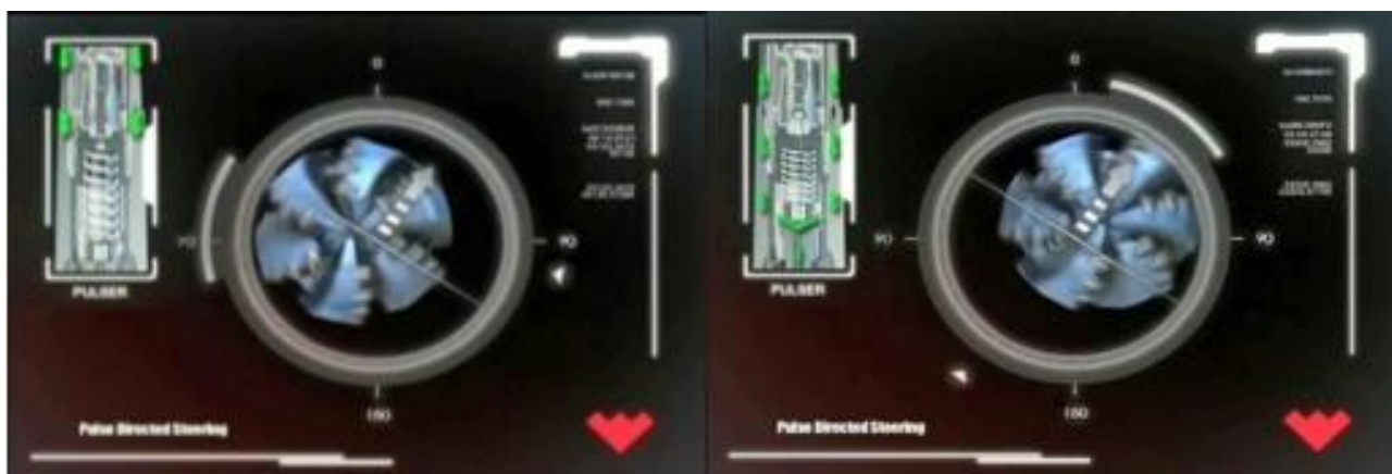
Рисунок 3 – Принцип действия пульсатора в открытом–закрытом состоянии
