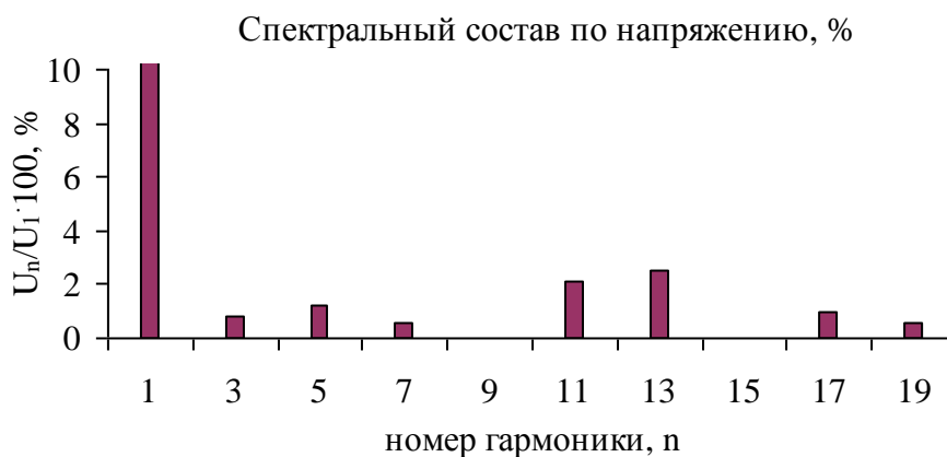
Рисунок 2 – Спектр напряжений при отключенных БСК
