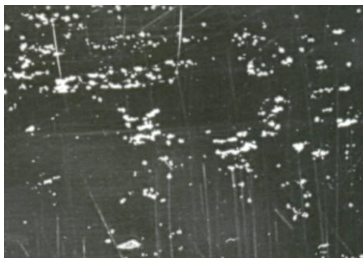
Рисунок 2 - Характер зарождения и развития коррозионного растрескивания стали X70
