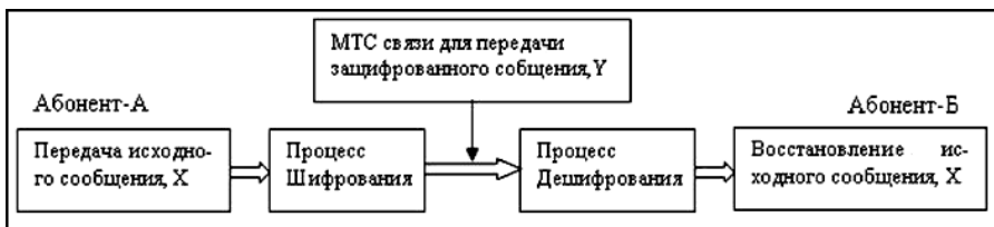
Рис. 1. Структурно-функциональная схема защиты информации от несанкционированного доступа
