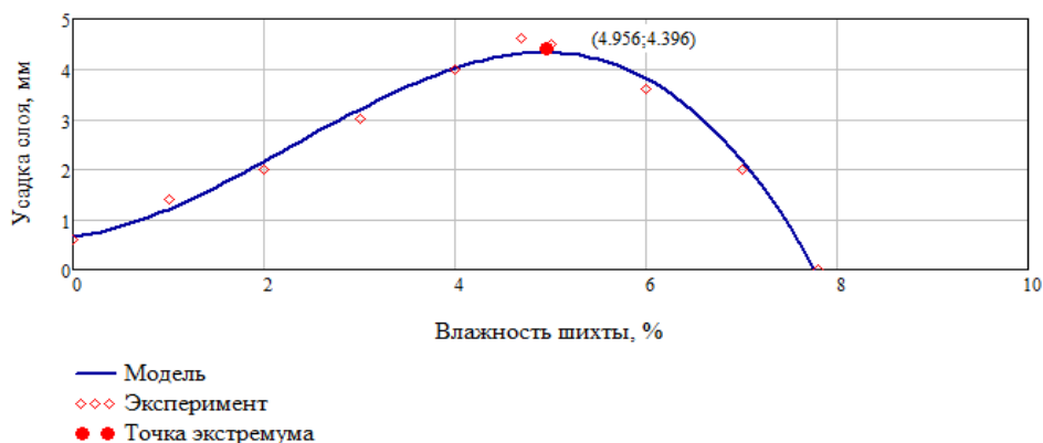
Рис. 3. Влияние влажности агломерационной шихты W (%) на усадку слоя шихты \Delta h (мм)
