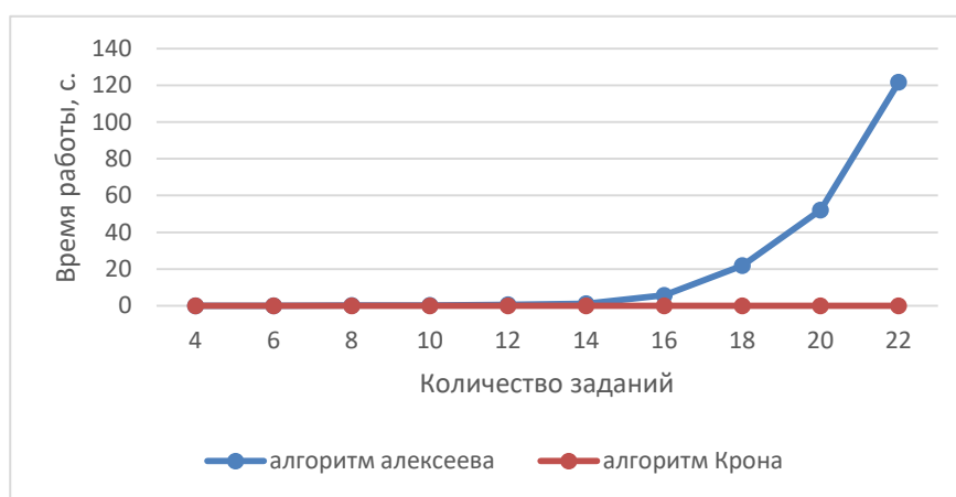
Рис. 4. Зависимость времени работы алгоритма Алексеева и алгоритма Крона от числа узлов и заданий
