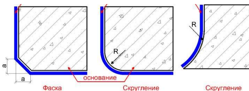
Рис. 1. Подготовка углов конструкции перед наклейкой тканых холстов
