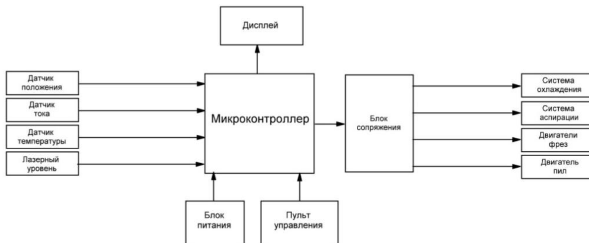
Рис. 1. Структурная схема блока управления фрезерно-пильным станком
