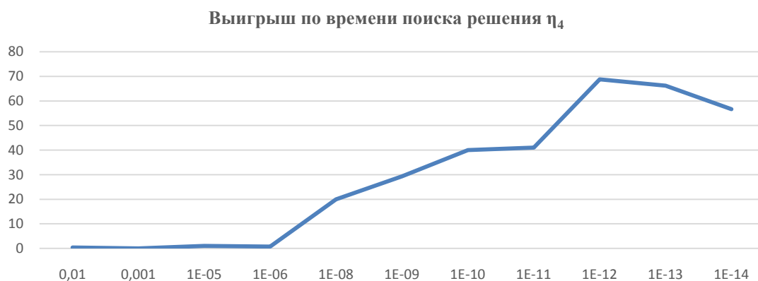
Рис. 4. Выигрыш по времени поиска решения \eta_4 метода перебора для поиска экстремума, использующего прогнозирование для разной точности
