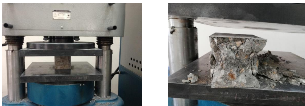
Рис. 2. Испытание бетонных образцов на прочность
