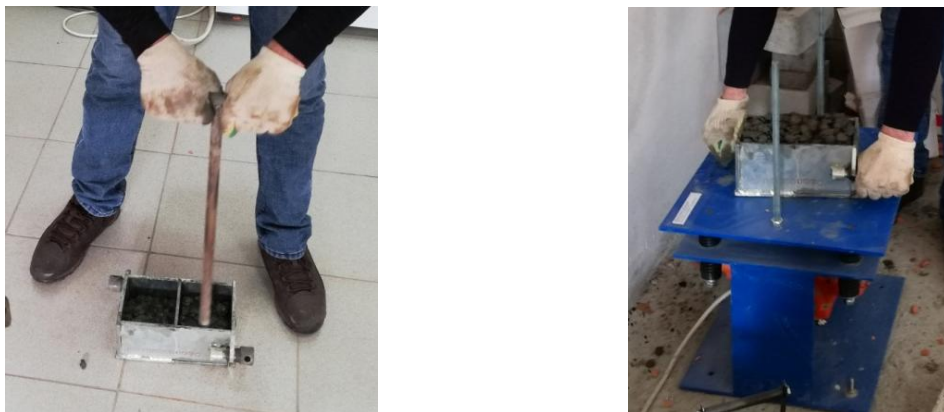
Рис. 1. Штыкование и вибрирование бетонной смеси
