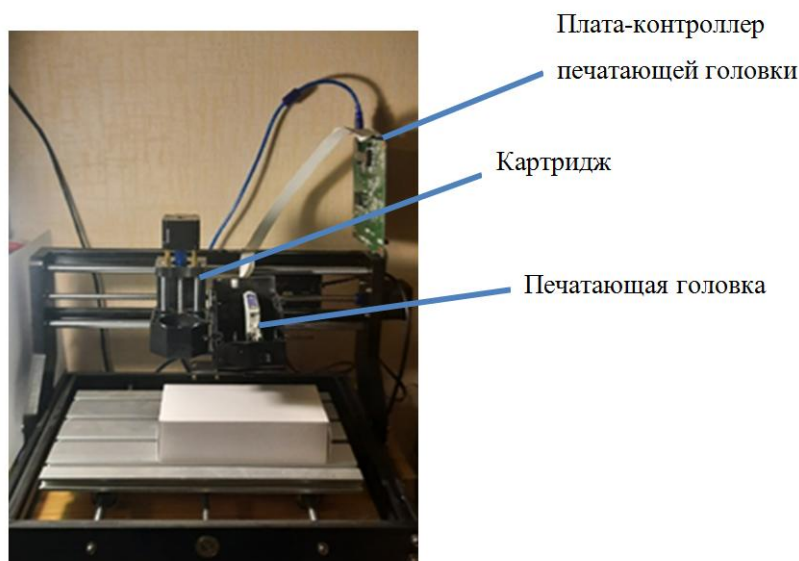
Рис. 3. Установка для нанесения перовскитных слоев
