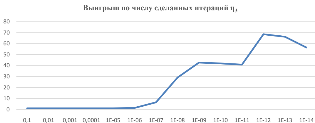
Рис. 3. Выигрыш по числу сделанных итераций \eta_3 метода перебора для поиска экстремума, использующего прогнозирование для разной точности
