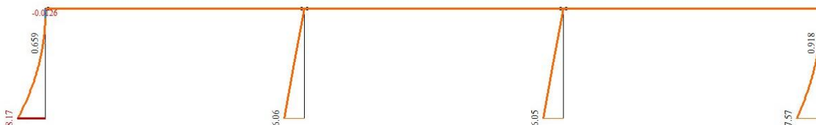
Рис. 9. Эпюра изгибающих моментов от действия горизонтальных сил
