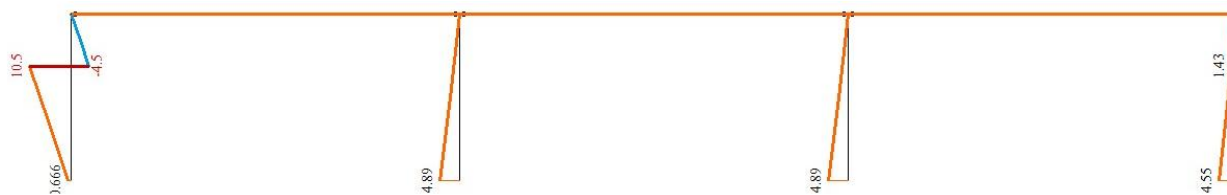
Рис. 10. Эпюра изгибающих моментов от действия сосредоточенного момента
