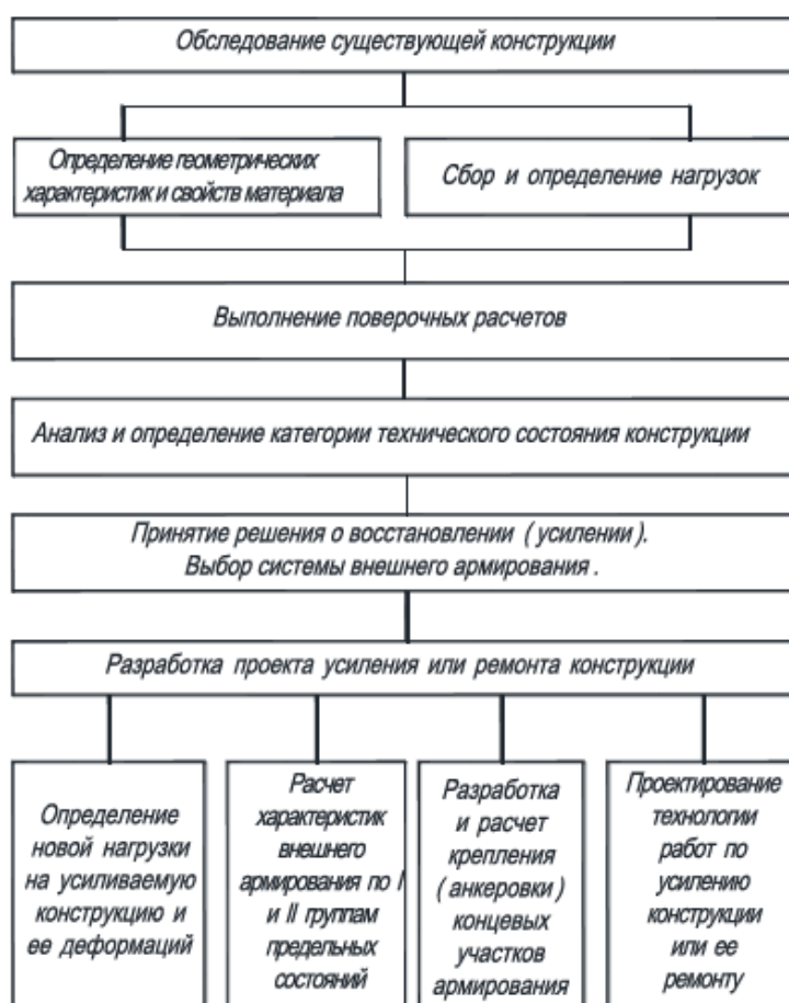
Рис. 2. Блок-схема проектирования усиления СВА
