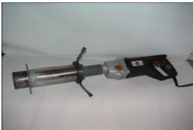
Рис. 3. Прибор механического (эталонного) метода определения прочности бетона: установка для выбуривания образцов – кернов из конструкции
