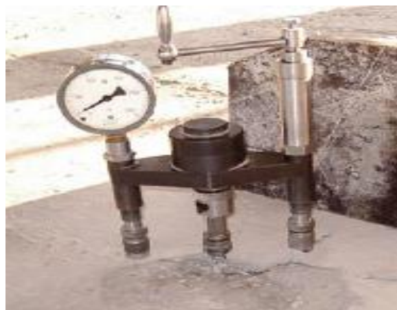
Рис. 4. Прибор механического (эталонного) метода определения прочности бетона: ГПНВ-5
