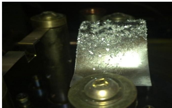
Рис. 2. Игольчатые монокристаллы оксида молибдена VI \text{MoO}_3 в процессе роста
