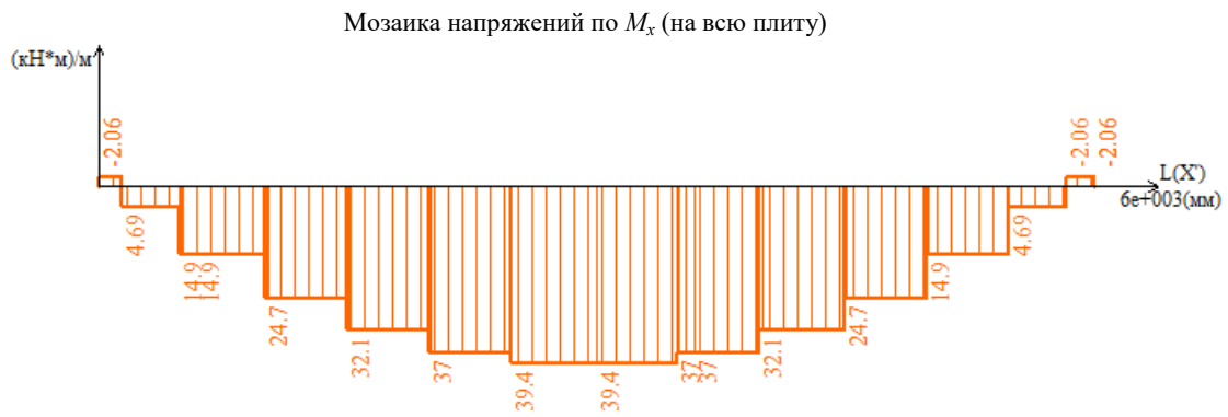
Рис. 4. Эпюра изгибающих моментов вдоль пролета
