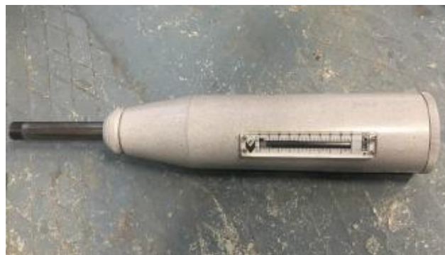
Рис. 2. Прибор неразрушающего контроля прочности бетона: склерометр
