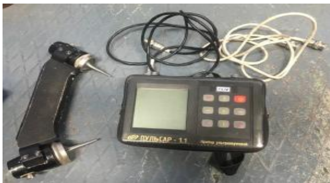
Рис. 1. Прибор неразрушающего контроля прочности бетона: ультразвуковой прибор «Пульсар»
