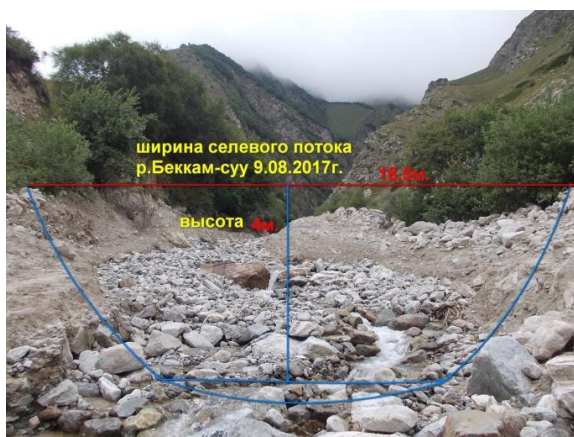
Рис. 3. Параметры русла после прохождения селевого потока в середине долинной части р. Беккам-суу (фото ОЭИ ВГИ)
