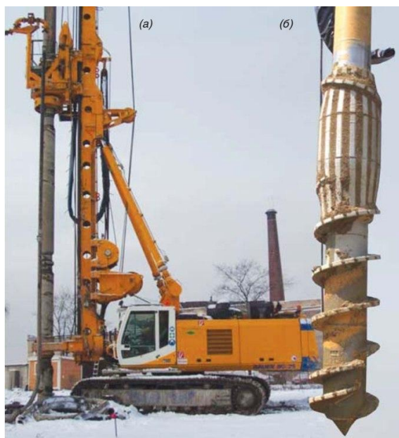
Рис. 1. Буровой станок для устройства свай уплотнения и его рабочий орган
