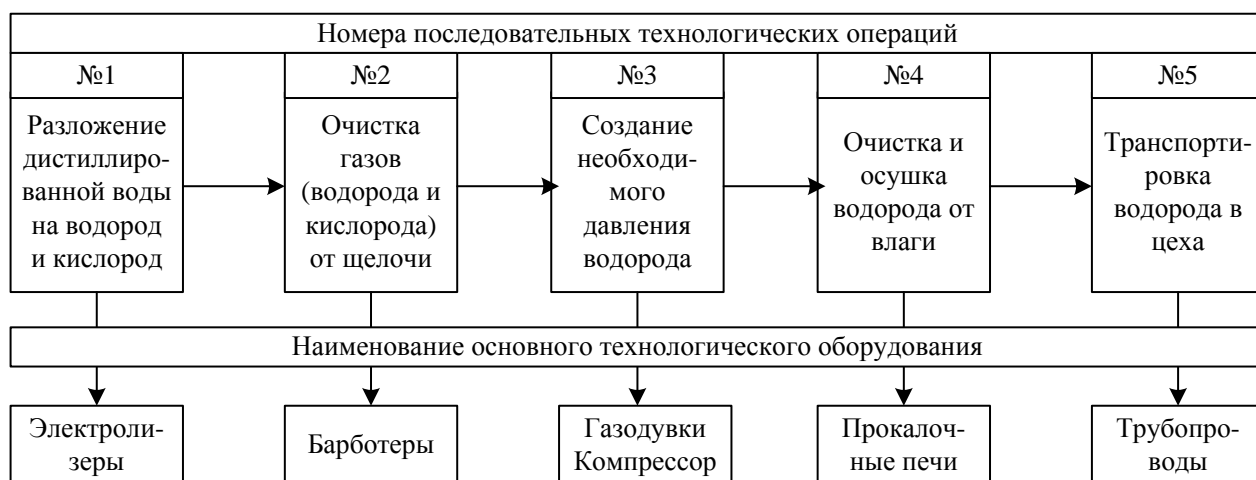
Структурная технологическая схема производства водорода
