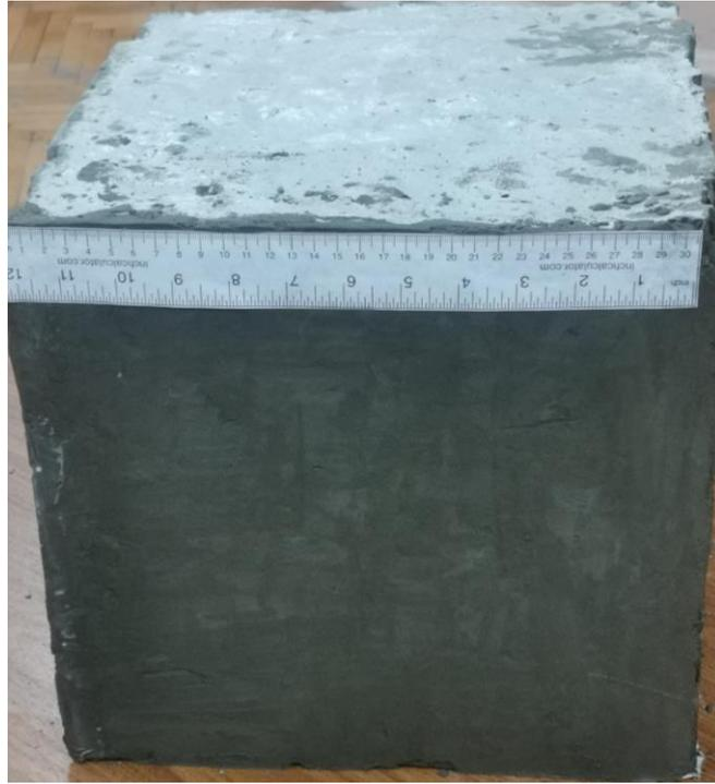
Рисунок 3.4 – Контрольный образец бутобетона
