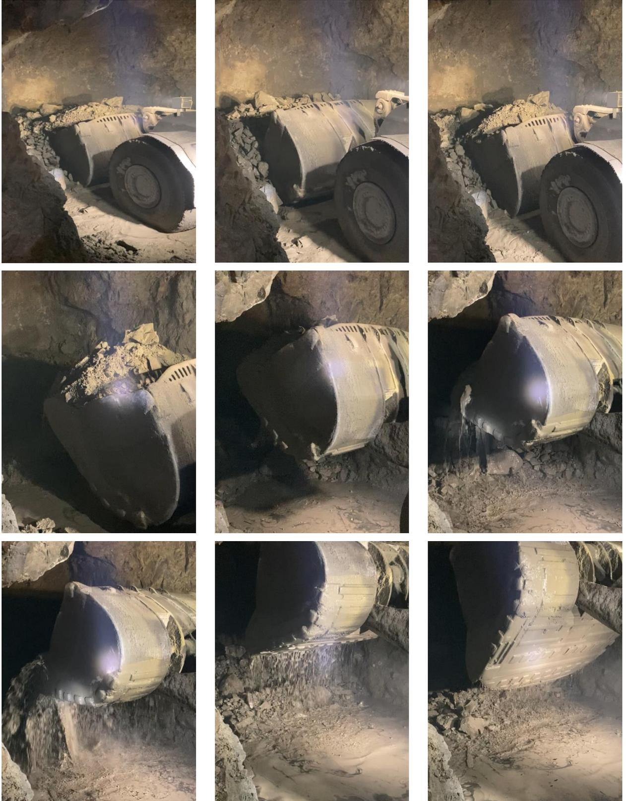
Рисунок 4.7 – Процесс приготовления бутобетонной твердеющей смеси
