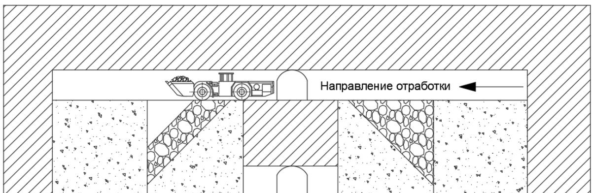
Рисунок 4.10 – Рекомендуемая схема закладки выработанного пространства, при изменении конструктивных параметров камеры
