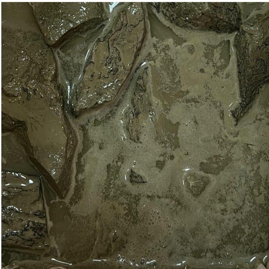
Рисунок 3.3 – Свежеприготовленная бутобетонная смесь
