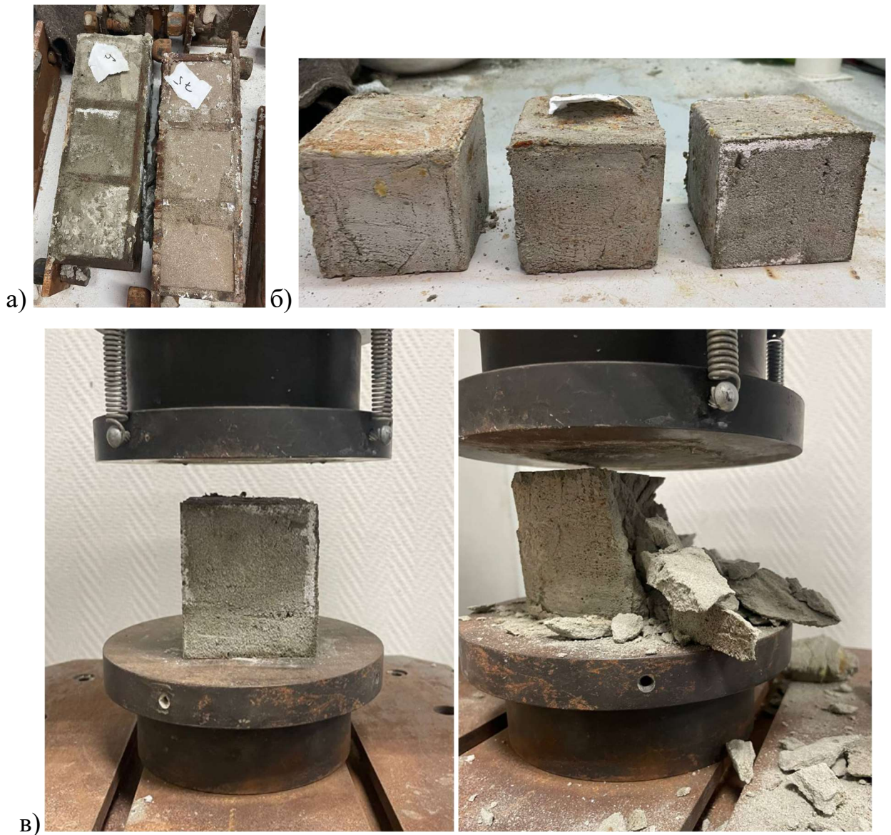
Рисунок 3.8. Этапы приготовления составов и форм образцов твердеющего закладочного массива: а – составы, залитые в формы, б – образцы с добавлением цемента после растаривания, в – образцы до и после испытания на прессе
