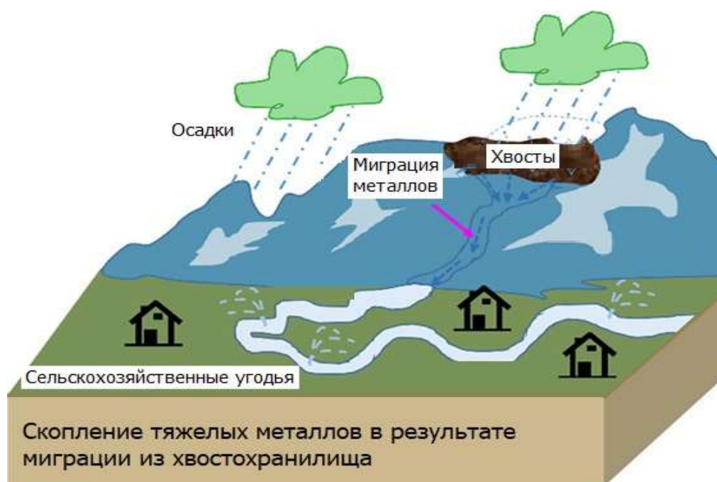
Рисунок 2. 2. Схема миграции химических элементов из хвостохранилищ, расположенных в гористой местности.
