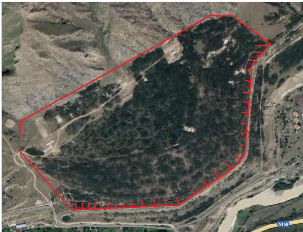
Рисунок 3.1. Вид сверху оконтуренного хвостохранилища №2 с нанесением направления намыва хвостов при складировании (направление намыва от юго-восточной дамбы (пляжная зона) на северо-запад (прудовая зона))
