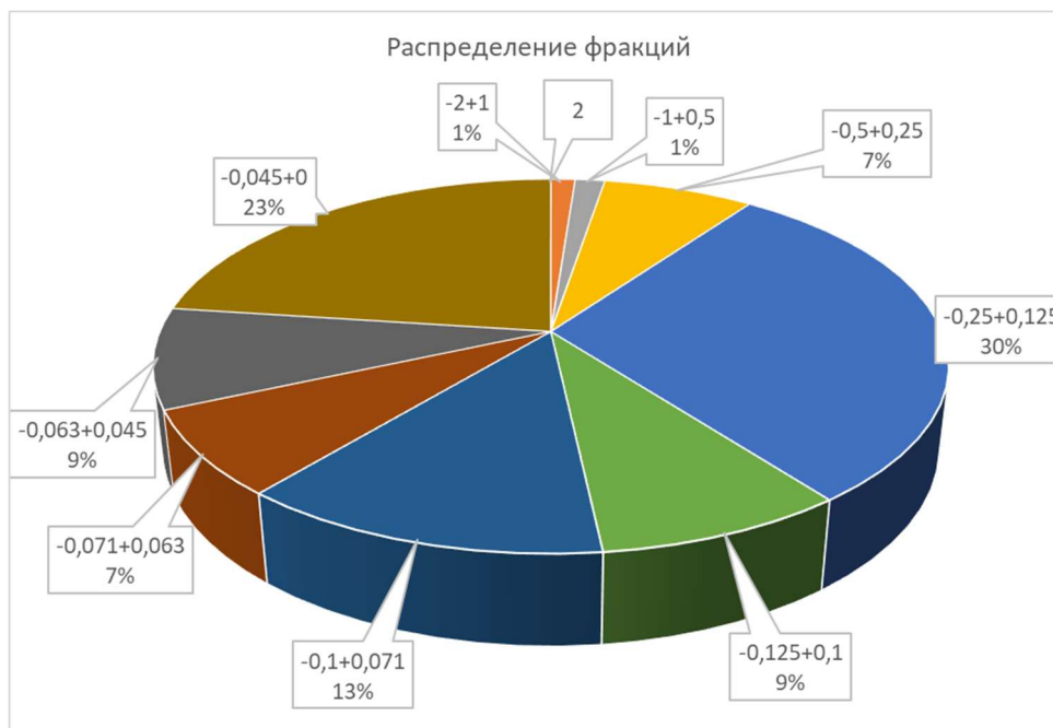
Рисунок 3.3. Диаграмма распределения классов крупности хвостов обогащения из хранилища №2
