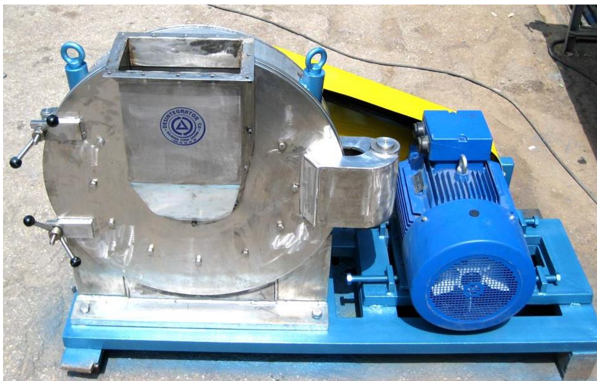
Рисунок 3.14 - Лабораторный дезинтегратор Горизонт – 380
